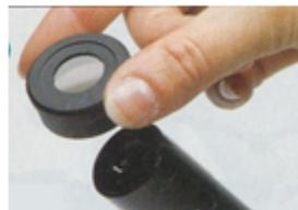
Le microscope polarisant est doté de deux polaroïds, l'analyseur et le polariseur
